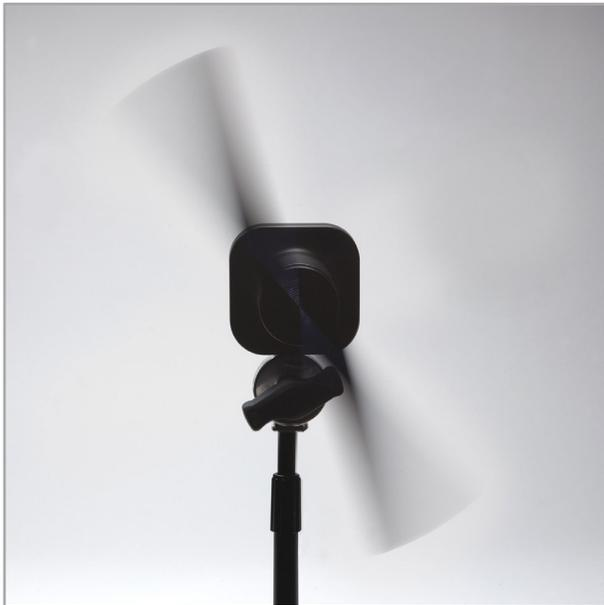
Al girar a una velocidad aproximada de 40 revoluciones por minuto y con cada uno de los focos LED programados para encender de manera independiente en el momento requerido, Vision One logra la proyección de hologramas; el movimiento mencionado hace desaparecer la base de los focos, dejando únicamente visible la constante animación del gráfico proyectado.
